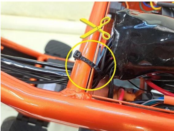
Katkaise johtosarjaa kannatteleva nippuside.
