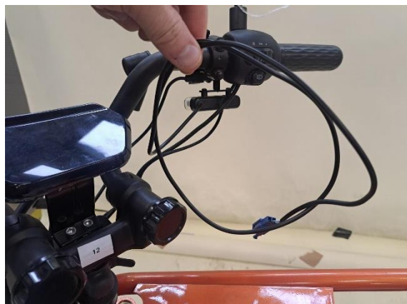
Ota oikean puolen etuvilkun johto irralleen johtosarjasta.
